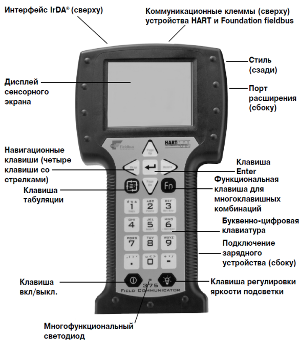
Рисунок Д.1 – Назначение элементов управления коммуникатора модели 375
