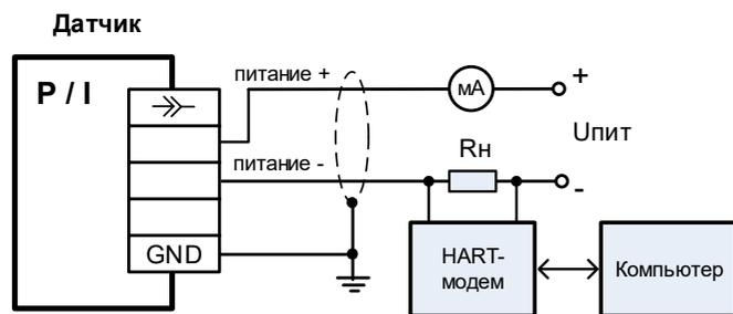
2-проводная линия (вых. сигнал – ток и HART)
