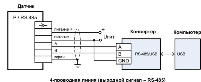
Рисунок 1 – Пример схемы подключения цифрового выхода RS-485 для 5-контактного разъема
