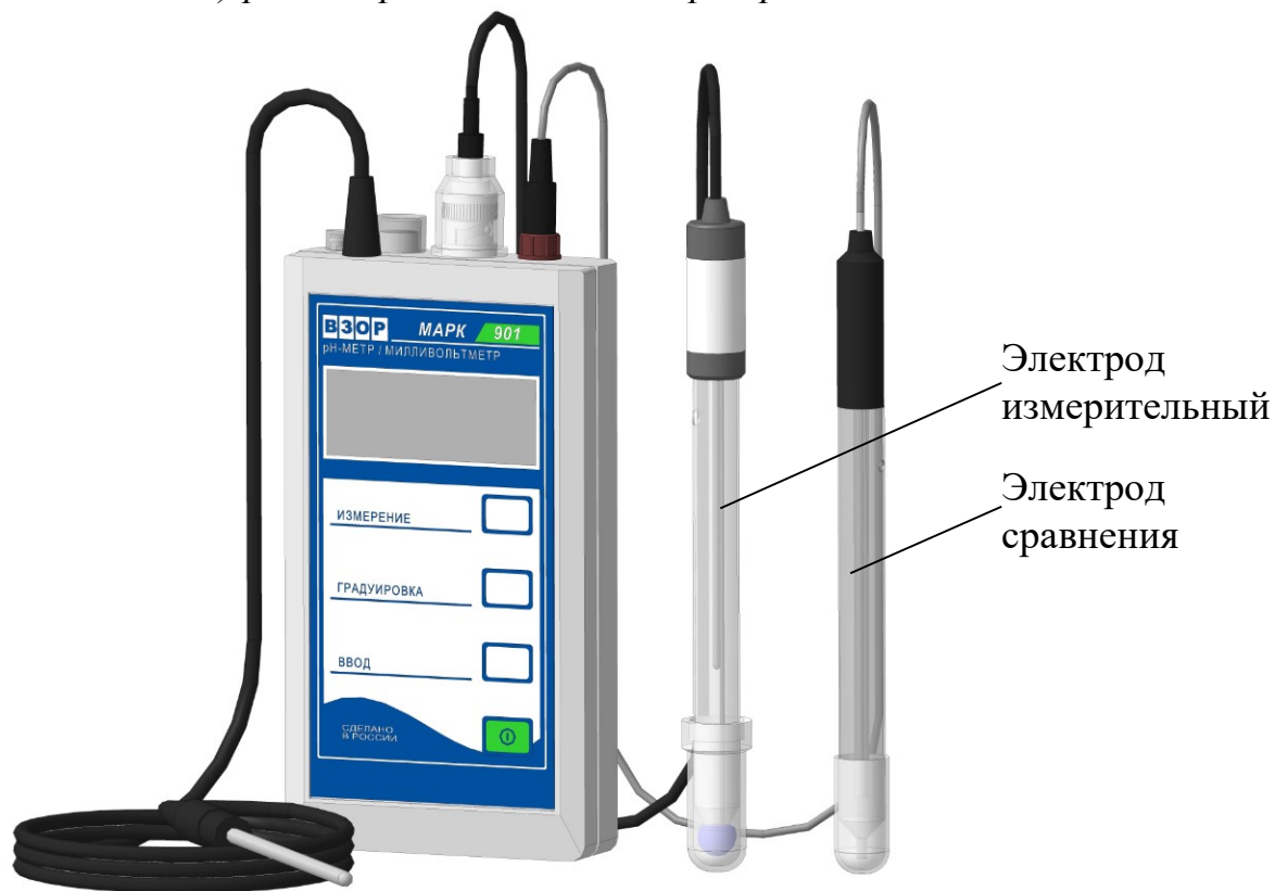
б) рН-метр/милливольтметр портативный МАРК-901/1
