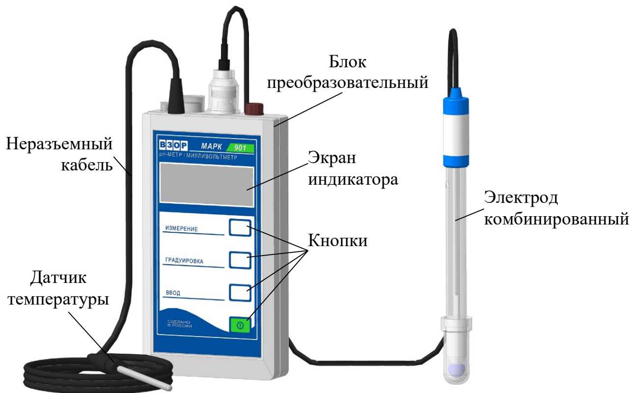
а) рН-метр/милливольтметр портативный МАРК-901
