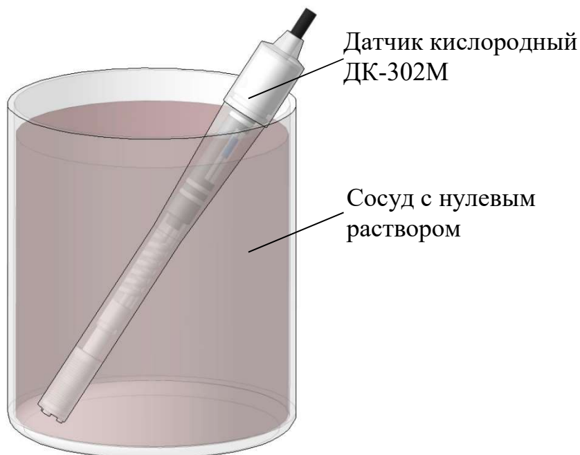
Рисунок 2.3 – Проверка показаний в «нулевом» растворе
